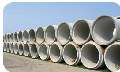
PCCP 管道生产
